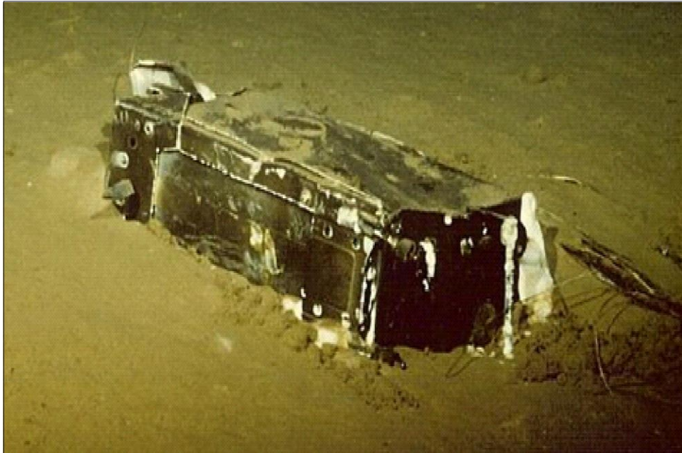
Figure I-5-7. Enregistreur de conversations de poste de pilotage d'un Boeing 747 Combi photographié à 4 500 m de profondeur dans l'océan Indien (accident survenu en 1987)
